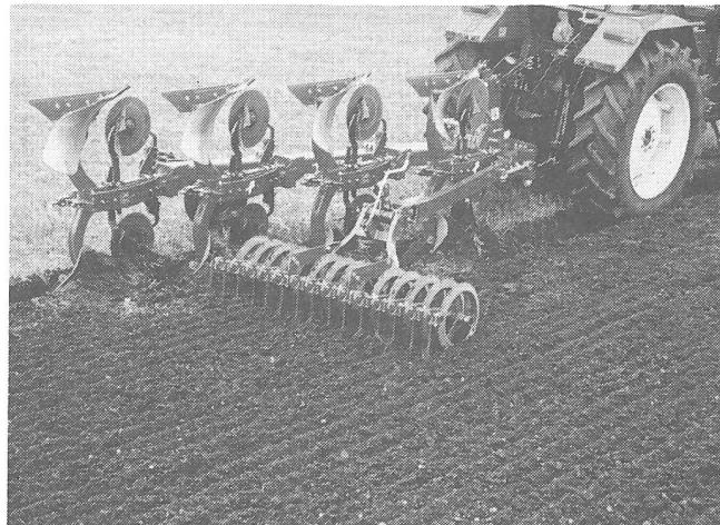
lung des Winkels, den die Packerringe laufen, ist es möglich, eine Gegenkraft zum Seitentzug des Traktors auszuüben. Tests haben gezeigt, dass dies eine Zugkraftersparnis von 18 bis 25 Prozent gegenüber dem traditionellen Verfahren ergibt. Durch die drehbare Anhängung des IP-Packers bleibt dieser
