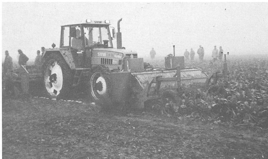
Hier werden die Zuckerrüben im Frontbereich entblättert und geköpft und im Heckbereich gerodet und auf Schwad abgelegt. Mit dieser fünfteiligen und zweiphasigen Erntemethode ist eine Flächenleistung von 2 ha pro Stunde unter günstigen Wetterbedingungen kein Problem.
