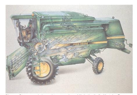
Die vom Strassenverkehrsrecht vorgegebene Höchstbreite limitiert den Bauraum. Die Leistungssteigerung muss deshalb mit einer wirkungsvolleren Dresch- und Abscheidetechnik erzielt werden.
