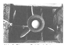
Abb. 5: Die vom Gebläseluftstrom angetriebene X1-Rotationsdüse hat sich als störungs- und reparaturanfällig erwiesen. Diese X1-Düsen sind problematisch für den Praxiseinsatz.
