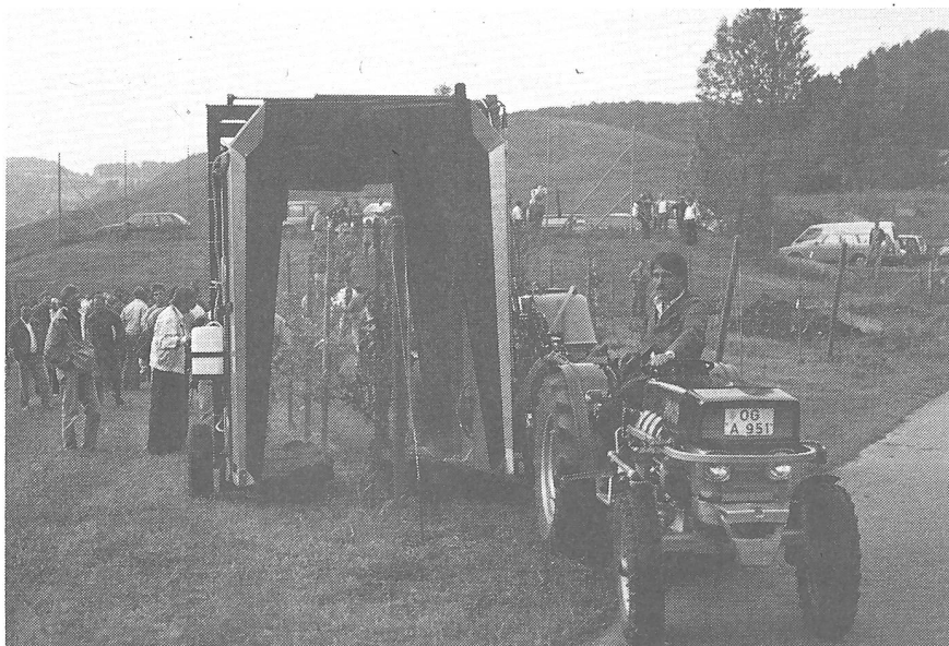
Abb. 6: Mit dem Tunnel-Recyclinggerät werden die Wirkstoffverluste deutlich reduziert. Über die ganze Saison sollten rund 30–40% der Präparate eingespart werden können.
