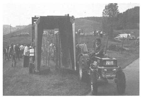
Abb. 6: Mit dem Tunnel-Recyclinggerät werden die Wirkstoffverluste deutlich reduziert. Über die ganze Saison sollten rund 30-40% der Präparate eingespart werden können.
