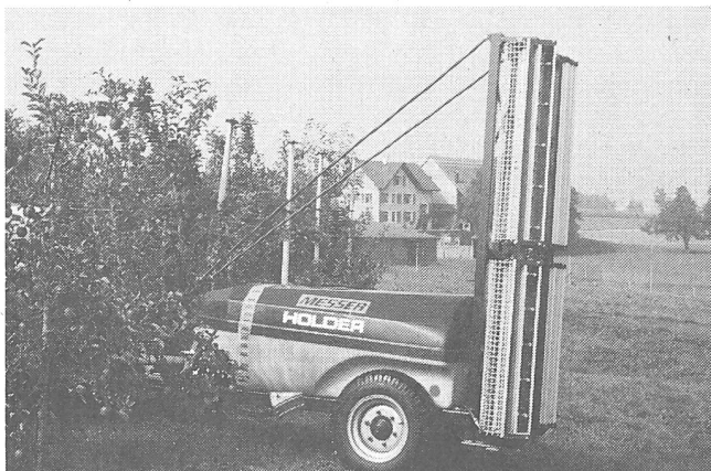
Abb. 3: Das Querstromgerät ist einfacher in der Handhabung und Einstellung, aber nur für max. 3 m hohe Bäume und in ebenem Gelände geeignet.
