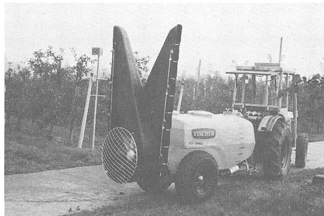
Abb. 4: Dieses Axialgerät mit Gebläseaufsatz erzeugt ebenfalls einen horizontalen Luftstrom. Die beiden Flügel können hydraulisch verstellt werden (Korrektur in Hanglagen, Anpassung an Laubwandform).
