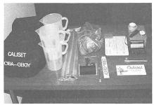
Abb. 8: Die Gebläsespritzen müssen jedes Jahr vor der ersten Behandlung auf die Kulturen eingestellt werden. Mit dem «Caliset», das alle Hilfsmittel beinhaltet, wird die Geräteeinstellung erleichtert.
