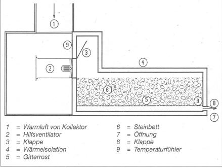
Abb. 2: Schnitt durch den Speicher beim Laden.
