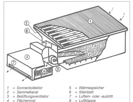
Abb. 1: Prinzipschema einer Heubelüftungsanlage mit Sonnenkollektor und Wärmespeicher.
