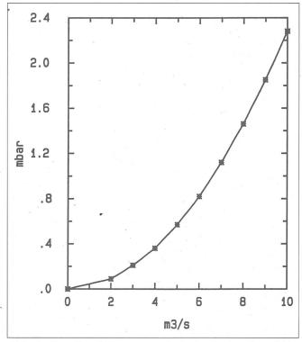
Abb. 6: Das Durchblasen von Luft durch das 1 m hohe Steinbett erfordert einen bestimmten Druck (mbar) je nach Luftmenge (m³/s).
