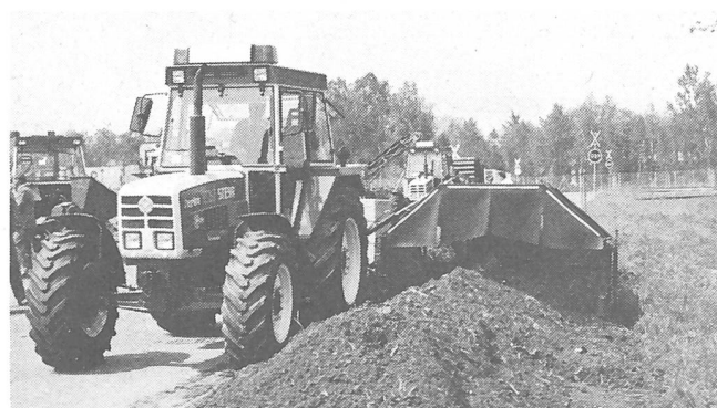
Steyr 8130A Kommunal (115 PS) im Einsatz mit Kompostumsetzer.
