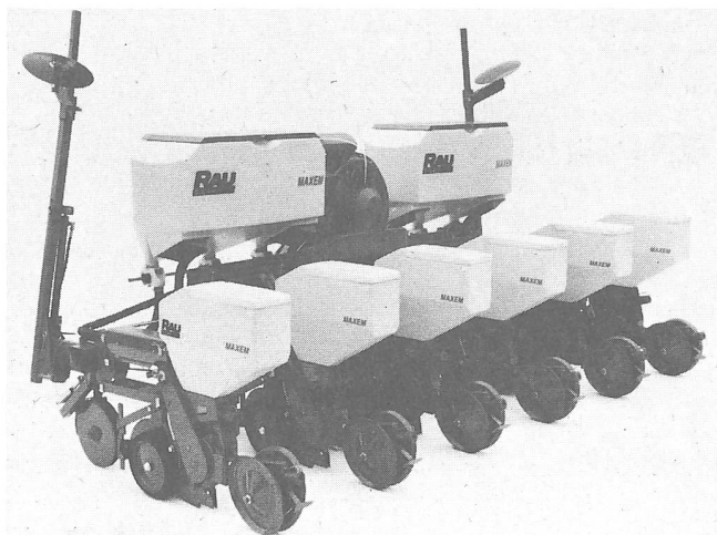
Pneumatische RAU-Maxem Einzelkornsämaschine für Direkt- und Mulchsaat (RAU Werkbild).
