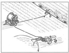
Die automatische Beregnungsmaschine für Wasser und Jauche
