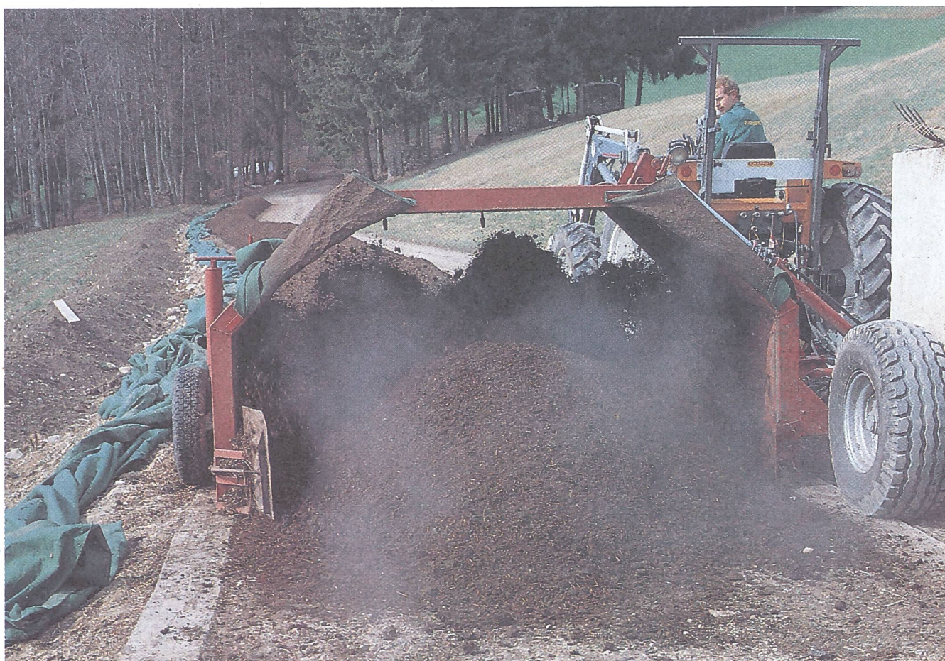
Feldwegkompostierung: vorbildlich erstellte Anlage im Zürcher Oberland. Die leichte Neigung des Feldweges gegen den Hang leitet das Wasser von der Miete weg. Die Bahnschwellenlage beidseits der Miete gewährleistet die niveaugleiche Führung des Umsetzgerätes durch die Miete. Dieser «Ausbaustandard» drängt sich keineswegs für die Gesamtlänge der Kompostwälle in einer Gemeinde auf, sondern beschränkt sich auf jene Distanz, die angemessen ist, um auch unter schlechten Witterungsbedingungen in der kalten Jahreszeit den Kompost zu betreuen.
