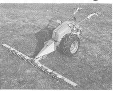
Dank dem neuen Mähbalken mit zwei verstopfungsfreien Schneidwerken. Passend zu allen RAPID- und AEBI-Mähern.
