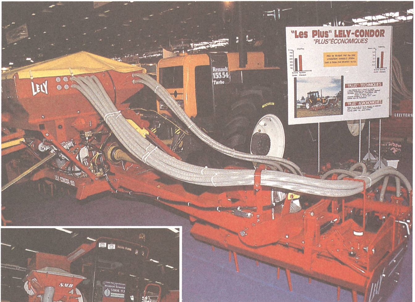
Gigantismus: Säapparat samt Kreiselegge je mit einer links- und einer rechtsseitigen Einheit, gedacht in Kombination mit einem Pflug zum Pflügen, Eggen und Säen in einem Arbeitsgang oder mit einer weiteren Kreiselegge (ohne Säapparate) für eine sechs Meter breite Saatbettbereitung in einem Durchgang.
