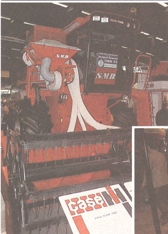
Pneumatischer Säpparat für den Aufbau am Mähdrescher.
