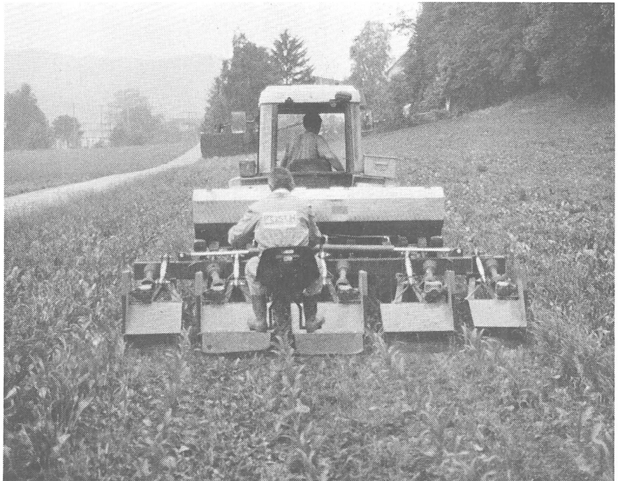
Abb. 5: Die Streifenfrässaat in Wiesen in Verbindung mit dem Zwischenreihen-mulchschnitt ermöglicht einen hervorragenden Schutz gegen Erosion und Nitratauswaschung. Mulchen kommt den Landwirt leicht teurer zu stehen als das Hacken oder eine Flächenspritzung.
