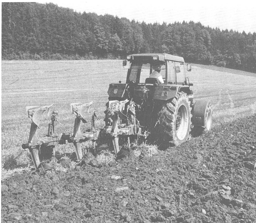
Abb. 2: Pflügen schafft einen «sauberen Tisch», lockert Bodenverdichtungen intensiv und bekämpft störende Verunkrautung effektiv. Der Pflug ist aber der Hauptverursacher der Bodenerosion im Maisanbau.
