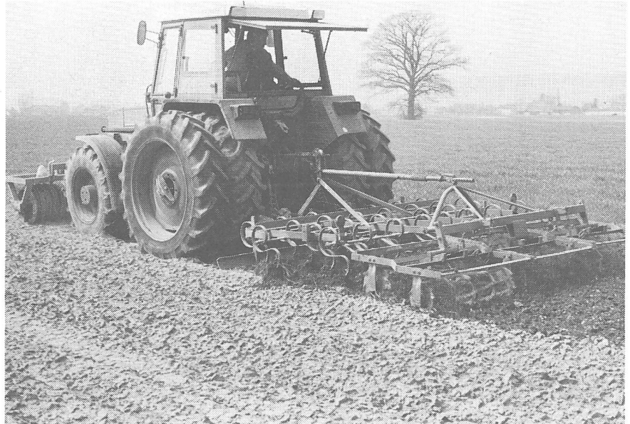
Abb. 3: Die Mulchsaat mit ganzflächiger Bodenbearbeitung (hier mit Zinkenrotor in Sonnenblumen) ist eine kostengünstige Variante, die keine speziellen Maschinen erfordert.
