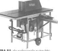
GEBA 85, die professionelle ausbaufähige Normfräse. Stark, solid und sicher. Grosser Fräsetisch, Spaltvorrichtung zum Anbauen und diversem weiteren Zubehör.
