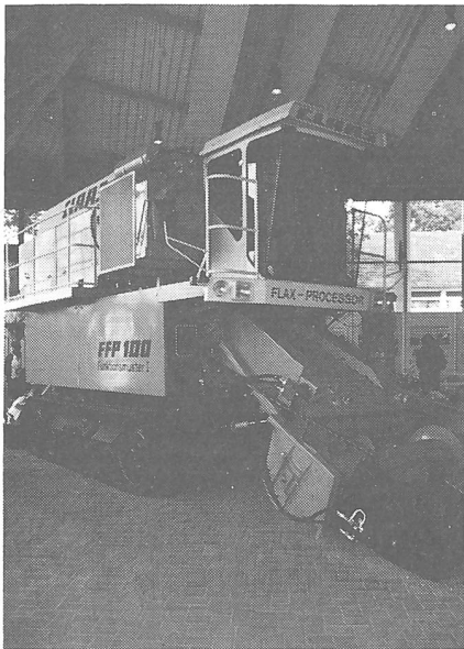
Technik von morgen: Prototyp eines Flachs-Prozessors, der den Flachs ab Schwad handelsfertig für die Industrie aufbereitet ...
