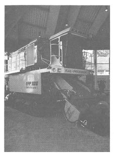
Technik von morgen: Prototyp eines Flachs-Prozessors, der den Flachs ab Schwad handelsfertig für die Industrie aufbereitet ...
