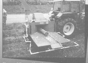
Einzugsöffnung 40 x 40 cm. Einfache Beschickung, auch für Kran geeignet, elektronische Einzugssteuerung.
