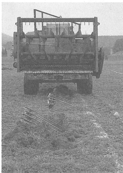
Abb. 2: Der konventionelle Mistzetter bei der Überfahrt über die Bollingsonden auf dem Standort «Aadorf». Die Bollingsonden bestehen im wesentlichen aus einem mit Wasser gefüllten Kunststoffrohr, an dessen einen Ende ein Manometer und an dessen anderen ein Druckmessschlauch («Ballon») befestigt ist.
