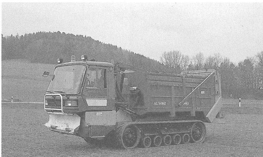
Abb. 1: Der Klärschlammzetter mit dem Gummibandlaufwerk der Firma Caterpillar, der von der Firma Salzmann AG, Boll in Eigenregie gebaut wurde.
