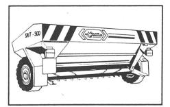
Salz-, Splitoder Sandstreuer, Anhängermodell. Arbeitsbreite 1.60 m bis 2.50 m
