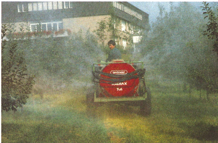
Gute Spritzeneinstellung bedeutet weniger Abdrift und Abtropfverluste.
