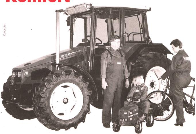
Same Explorer II 70, 4l Motor, 70 PS, 22.5% Drehmomentanstieg, Synchropower, 30/30 Gänge, echte 4-Radbremsen, Komfortkabine, abgesenkte Motorhaube für freie Sicht, in der Grundausrüstung ab Fr. 64'000.-
