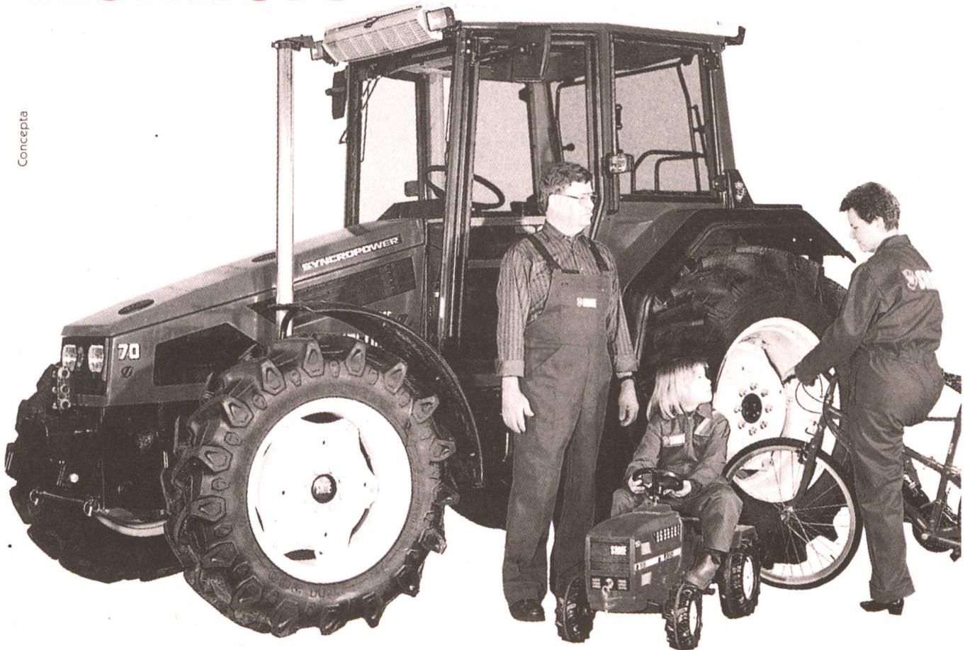
Same Explorer II 70, 4l Motor, 70 PS, 22.5% Drehmomentanstieg, Synchropower, 30/30 Gänge, echte 4-Radbremsen, Komfortkabine, abgesenkte Motorhaube für freie Sicht, in der Grundausstattung ab Fr. 64'000.-
