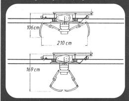
Hallenlaufkran KIWA-Elektrolift 2 TR-S, optimale Raumausnützung und Zwei-Waben-Trägerbrücke, Hydraulikgreifer, Traglast 1250 kg, Hubgeschwindigkeit 15 und 30 m/min.
