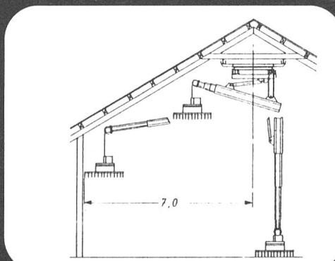
Hängedrehkran KIWA-Hydrofix 3 V-H mit dreifachem hydr. Teleskopausleger, Hydraulikgreifer an zwei getrennten Lastseilen, max. Traglast 1000 kg, Hubgeschwindigkeit 30 m/min.
