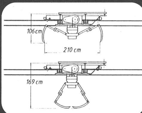
Hallenlaufkran KIWA-Elektrolift 2 TR-S, optimale Raumausnutzung und Zwei-Waben-Trägerbrücke, Hydraulikgreifer, Traglast 1250 kg, Hubgeschwindigkeit 15 und 30 m/min.
