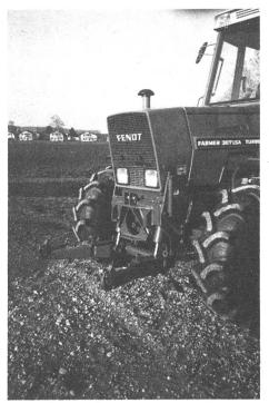
Die vorstehenden Hubarme der Fronthydraulik sollten bei längerem Nichtgebrauch eingeschwenkt oder mit wenigen Handgriffen demontiert werden können. Auch das montierte Schnellkupplerdreieck verringert die Unfallgefahr. Eine in die Traktorfront gut integrierte Frontzapfwelle verbessert die Einsatzmöglichkeit von Gelenkwellen mit genügender Schiebeteillänge.
