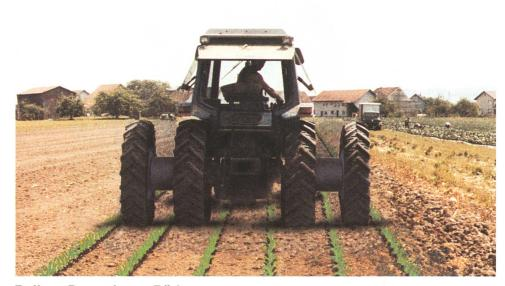
Reihen-Doppelspur-Räder für Hack- und Pflegearbeiten, mit jeder gewünschten Zwischenbreite.
