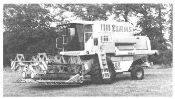
Detail ist der neue Multicrop-Dreschkorb, den jetzt serienmässig alle grösseren Mähdrescher von Claas, vom Dominator 88 Classic bis zum 118 SL Maxi, erhalten. Er besteht aus einem fest eingebauten Korbrahmen und drei auswechselbaren Segmenten. Diese können bei Fruchtwechsel oder auch bei Beschädigungen durch Fremdkörper schnell und ohne Abbau des Einzugskanals ausgetauscht werden. Auch die Reinigung des Korbes ist dadurch noch erleichtert worden. Service Company AG, Oberbipp
