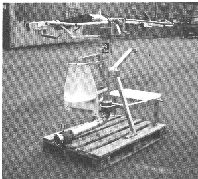
Abb. 1: Prüfstand zur Messung der Querverteilung. Versuche mit Gülle sind relativ aufwendig, da die Anlage nach jedem Durchgang versetzt werden muss.
