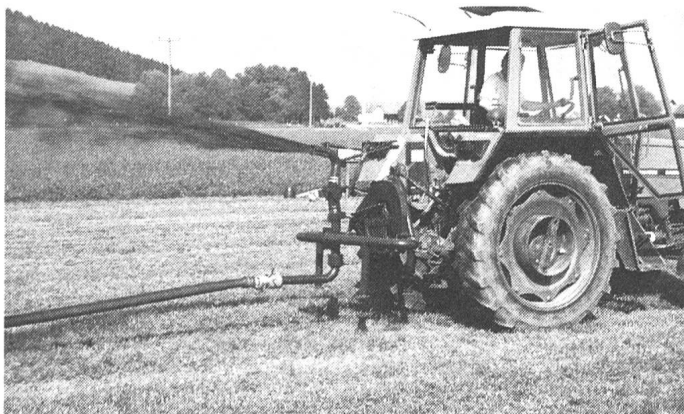
Abb. 3: Schwenkverteiler mit Antrieb über die Zapfwelle (Meier-Perfekt). Bei den Verteilern mit Keilriemenantrieb schwenkt die Düse in horizontaler und vertikaler Richtung. Die Schwenkfrequenz wird über die Drehzahl der Zapfwelle reguliert.
