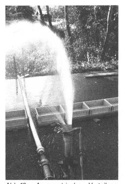
Abb.10: Asymmetrische Verteilung beim Schwenkverteiler: Durch den seitlichen Austritt des Strahls entstehen im Extremfall Abweichungen in der Verteilbreite von bis zu 5 m Unterschied zwischen linker und rechter Seite.
