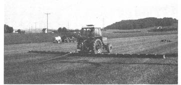
Abb. 1: Prüfstand zur Messung der Querverteilung. Versuche mit Gülle sind relativ aufwendig, da die Anlage nach jedem Durchgang versetzt werden muss.
