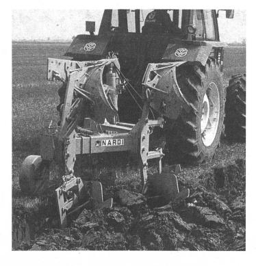
bau ermöglicht es, den Pflug seitlich so zu versetzen, dass das Offset-Pflügen wie auch das End-Pflügen möglich ist. Beim End-Pflügen kann die letzte Furche an einer stehenden Kultur entlang gezogen werden, ohne diese Pflanzen niederzuwalzen, und dies auch mit Doppelrädern.
