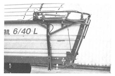
Rückwand erfolgen weiterhin über ein einfach wirkendes Hydrauliksystem bequem vom Traktorsitz aus. Neu ist, dass die Rückwand beim Schliessen durch einen Zusatzmechanismus automatisch verriegelt wird.
