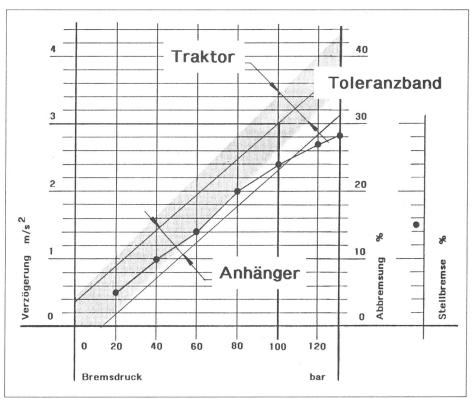
Bremsverzögerung (m/sec²) bzw. Abbremsung (%) in Abhängigkeit der Druckzunahme eines hydraulisch gebremsten Anhängers.
