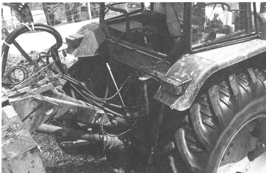
Knickdeichsel am Lade- oder Erntewagen: nützlich für das ungehinderte Fortkommen auf der schiefen Ebene und ungleichmässigen Oberfläche des Siliergutes im Fahrsilo.
