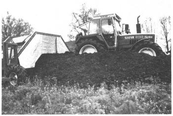
Das Wenden, Mischen und Durchlüften der Kompostmieten erfolgt mit Umsetzgeräten. Sie werden von Traktoren betrieben, die dazu über 60 PS Motorleistung und Superkriechgänge verfügen müssen.
