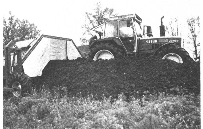
Das Wenden, Mischen und Durchlüften der Kompostmieten erfolgt mit Umsetzgeräten. Sie werden von Traktoren betrieben, die dazu über 60 PS Motorleistung und Superkriechgänge verfügen müssen.
