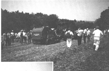
Rundballenpresse mit Vorbauhäcksler. Letzterer soll für verlustärmeres Silieren und dichtere Ballen sorgen, die sich zudem leichter auftrennen und verteilen lassen.
