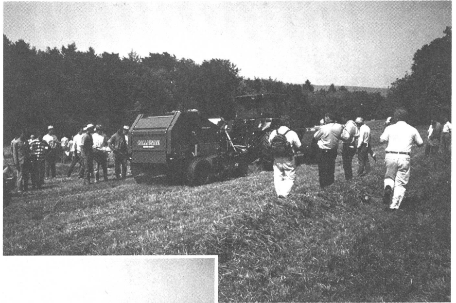
Rundballenpresse mit Vorbauhäcksler. Letzterer soll für verlustärmeres Silieren und dichtere Ballen sorgen, die sich zudem leichter auftrennen und verteilen lassen.
