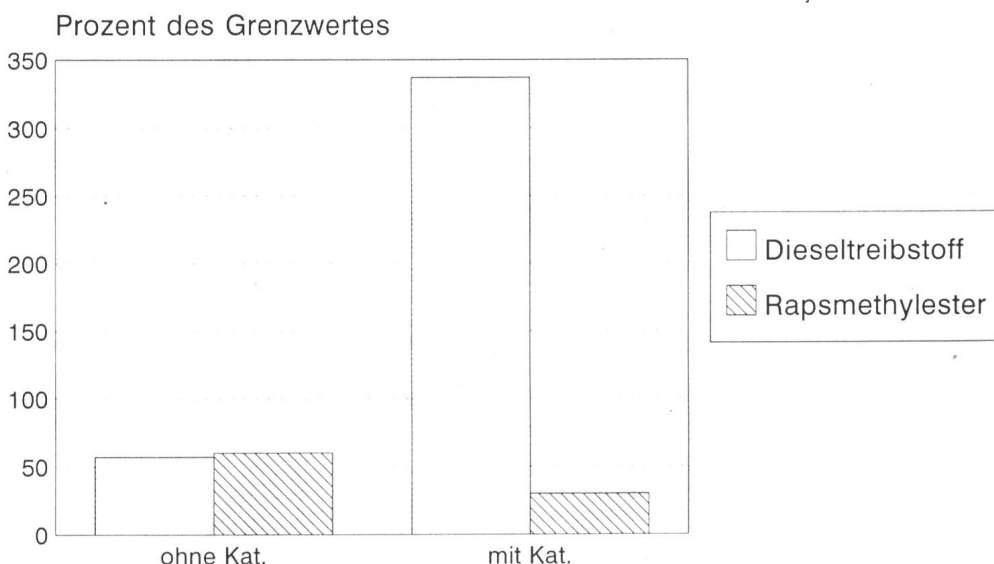
Abb. 5: Partikelemissionen ohne und mit Katalysator Mercedes-Motor mit Diesel und Biodiesel im 13-Stufen-Test
