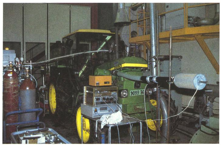
Obwohl Traktoren nicht unter die Abgasemissions-Verordnung (FAV 2) fallen und der 13-Stufen-Test dem praktischen Lastkollektiv schlecht entspricht, wurden zu Vergleichszwecken die Abgasmessungen an den Traktoren mit RME und Dieseltreibstoff doch dieser Testvorschrift gemäss durchgeführt. (Fotos und Abbildungen: FAT Tänikon)
