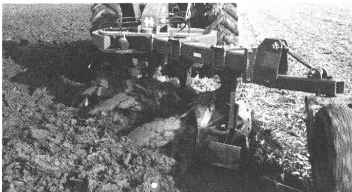
Abb. 1: Schwenkpflug (Howard): Die Arbeitsrichtung wird durch Schwenken des Pflugbaums geändert, so dass wie mit einem normalen Drehpflug gefahren werden kann.
