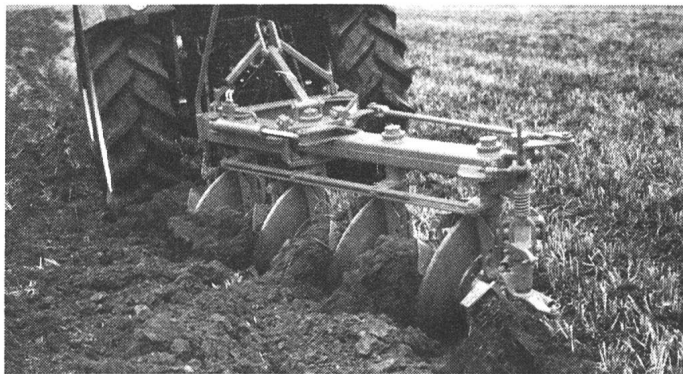
Abb. 3: Der Scheibenschwenkpflug (Galucho) ist stark verstopfungsanfällig.
