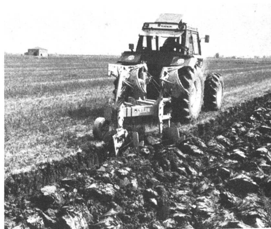
Abb. 11: Die Bildung von Pflugsohlen und die Unterbodenverdichtungen könnten mit «Offset-Pflügen» wesentlich vermindert werden (Photo Nardi).
