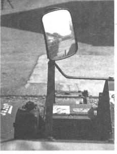
Grosszügig dimensionierte, schräg gestellte Spiegel auf dem Frontanbaugerät geben Sicherheit bei unübersichtlicher Verkehrssituation. Das gelbe Schutztuch hat eine gute Signalwirkung.
