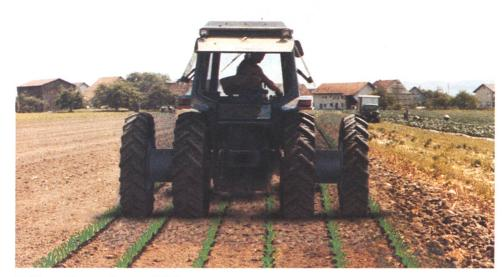
Reihen-Doppelspur-Räder für Hack- und Pflegearbeiten, mit jeder gewünschten Zwischenbreite.
