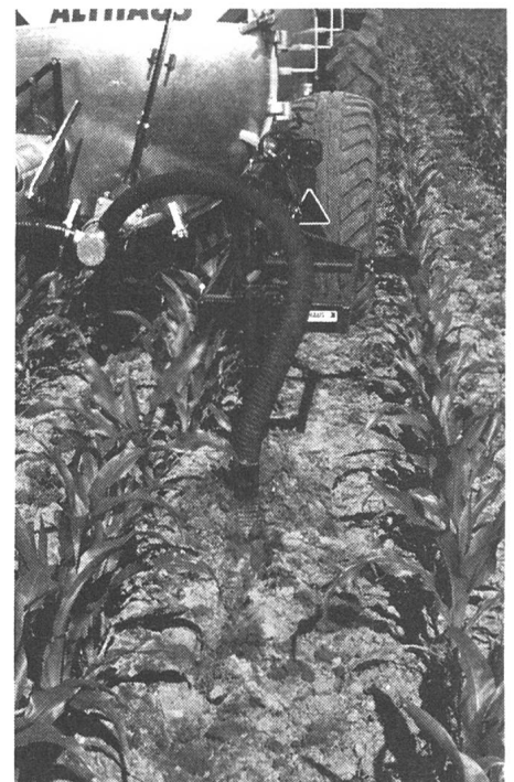
Abb. 9: Der Gülledrill erfordert eine exakte Maissaat und einen vollständig abgetrockneten Boden. Durch den Zinnachlauf erhöht sich der Zugkraftbedarf um das 2- bis 4fache.
