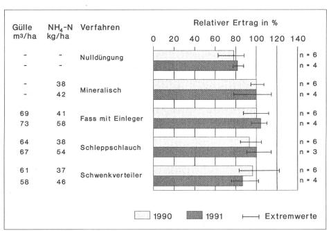
Abb. 7: Gülledüngung im Mais: Relative TS-Erträge in % in Abhängigkeit vom Ausbringverfahren. Mineralisch = 100% (Referenzverfahren). Durchschnittsertrag aller gedüngten Verfahren: 1990 = 97,2 dt/ha, 1991 = 124,1 dt/ha.
