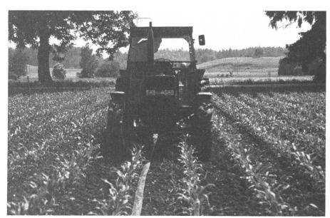
Abb.5: Wird mit PVC-Schläuchen gearbeitet, zieht der Schwenkverteiler den Schlauch während des Verteilens zwischen den gleichen Maisreihen zurück.
