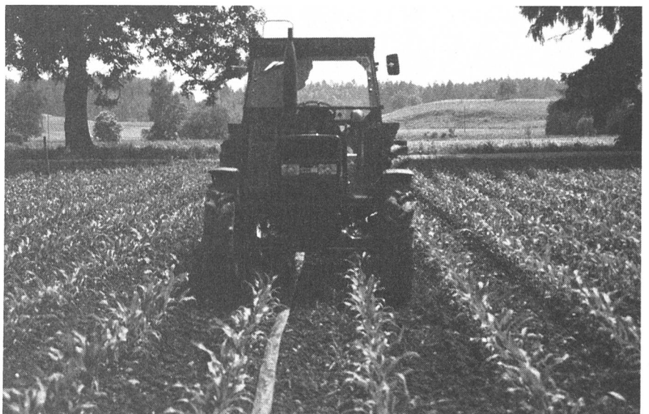
Abb.5: Wird mit PVC-Schläuchen gearbeitet, zieht der Schwenkverteiler den Schlauch während des Verteilens zwischen den gleichen Maisreihen zurück.
