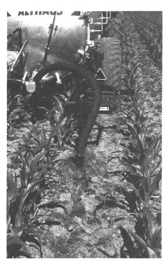
Abb. 9: Der Gülledrill erfordert eine exakte Maissaat und einen vollständig abgetrockneten Boden. Durch den Zinkennachlauf erhöht sich der Zugkraftbedarf um das 2- bis 4fache.
