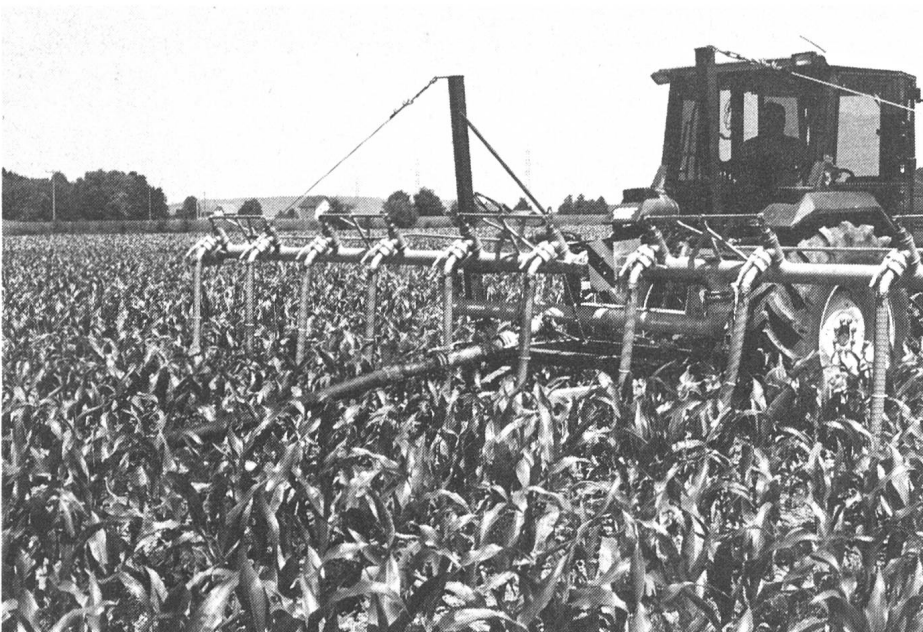
Abb.3: Beim Schleppschlauchverteiler fließt die Gülle direkt zwischen den Maisreihen auf den Boden, ohne dass die Blätter verschmutzt werden.
