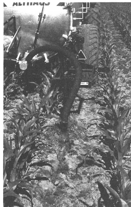
Abb. 9: Der Gölledrill erfordert eine exakte Maissaat und einen vollständig abgetrockneten Boden. Durch den Zinnachlauf erhöht sich der Zugkraftbedarf um das 2- bis 4fache.
