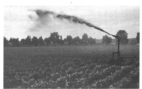
Abb.6: Der Regenautomat kommt dank der grossen Arbeitsbreite auf eine hohe Flächenleistung. Bei windigem Wetter und in der Nähe von Siedlungsgebieten ist sein Einsatz nicht zu empfehlen (Abdrift, Geruchsemissionen, schlechte Verteilung).
