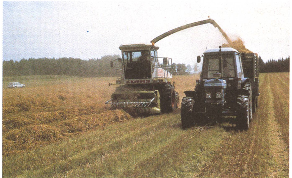
Abb. 2: Für das Strohhäckseln ab Feld sollten nur Maschinen mit Metalldetektoren oder Funkenlöschern eingesetzt werden. Der Funkenlöscher lässt sich in die Rohrleitung des Abladegebläses einbauen.
