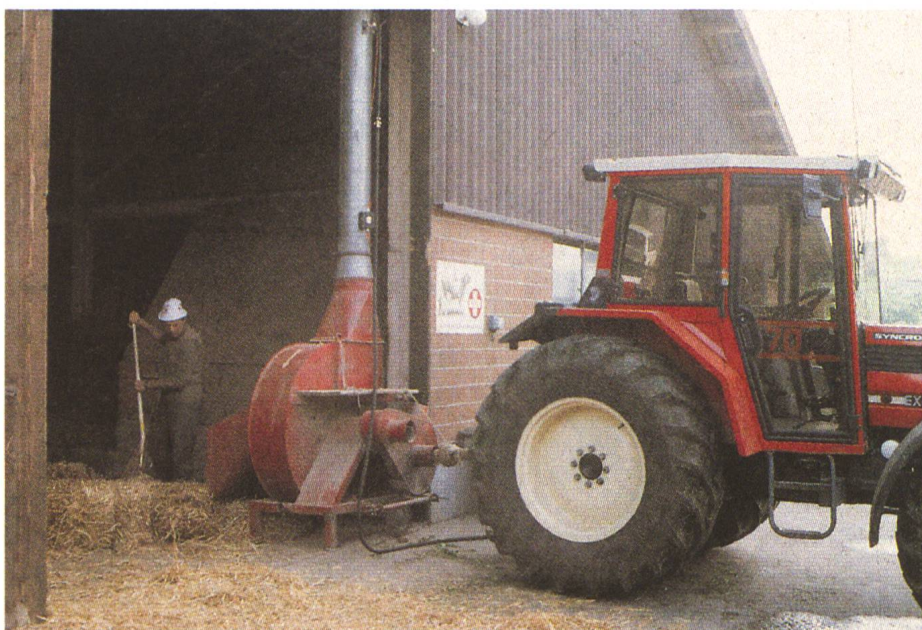
Abb. 1: Beim Strohmalen in die Scheune muss der Traktor im Freien stehen. Weiter ist ein ins Rohr eingebauter Funkenlöscher mit Detektoren und Lösch- düsen erforderlich. Er erkennt Funken und löscht sie in Sekundenbruchteilen.
