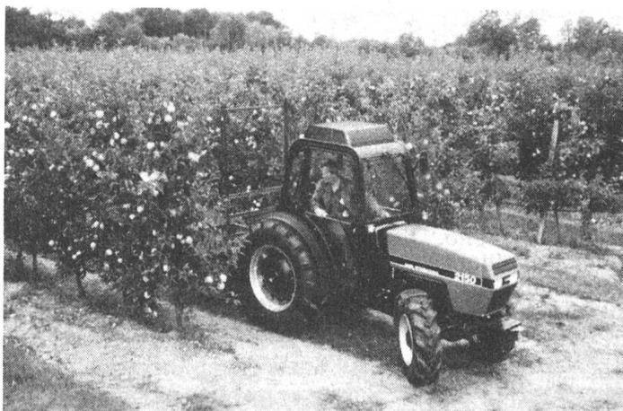
CASE-IH bietet ein komplettes Programm von Obst- und Weinbau-Traktoren in den Leistungsklassen 45 PS (33 kW) bis 75 PS (55 kW). Die Traktoren bestechen durch ihre Wendigkeit; dies dank einem Lenkeinschlag, der bei den Allradmodellen bis zu 55° beträgt – daraus resultiert ein Wendekreis von etwa 3,5 m. Hervorragend ist auch die Hydraulikleistung (die Pumpe fördert 59 l/min.). Das Hydraulik-
