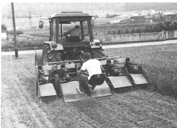
Das von Witzig konstruierte und gebaute Reihenmulchgerät schlägt den Pflanzenbewuchs durch Schlegel an einer rasch rotierenden, horizontalen Welle ab. Neuerdings ist sowohl der Front- als auch der Heckanbau möglich.
