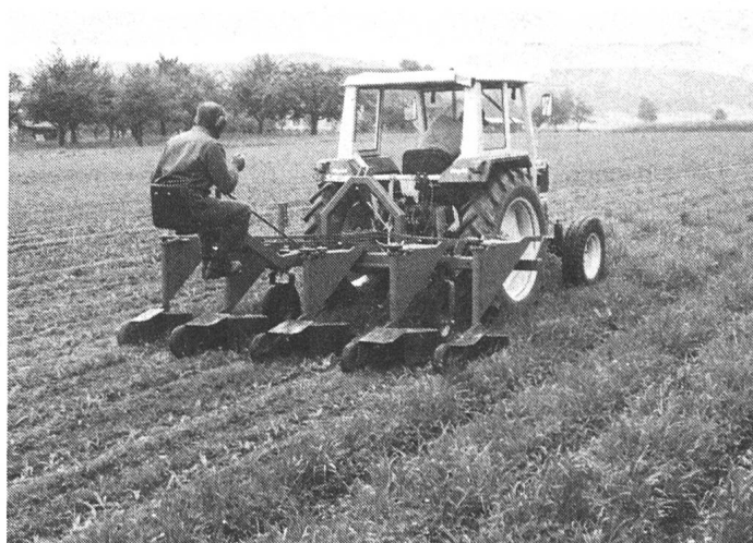
Von Josef Scheiwiller, Waldkirch SG, wurde ein Mulchgerät nach dem Rasenmäherprinzip entwickelt. Die Maschine zeichnet sich durch ein relativ geringes Gewicht und einen reduzierten Leistungsbedarf aus.
