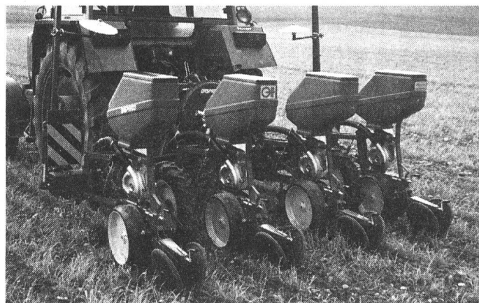
Abb. 1: Eine Mulchsaatausrüstung mit Doppelschneidscheiben und Tiefenführungsrollen, gut integrierten Säscharen sowie Scheibenzustreicher sichern eine verstopfungsfreie Direktsaat von Rüben (links) und Mais (rechts).
