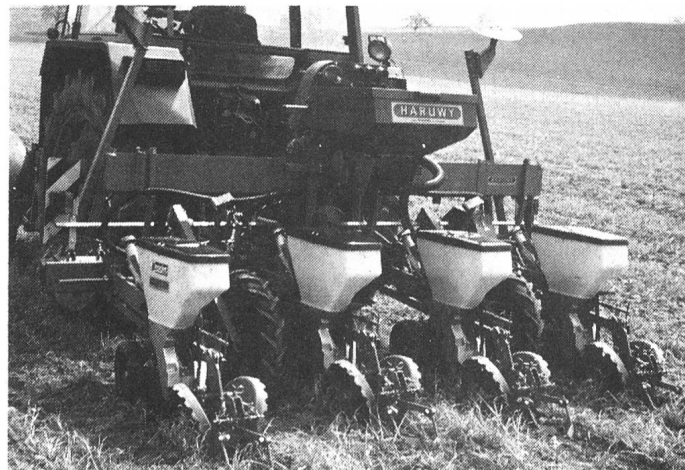
Abb. 5: Die Mais-Direktschachtsaat nach abgetötetem Grünroggen kann auf spurfreien Böden auch mit herkömmlichen Einzelkornsämaschinen mit Schneidscheiben durchgeführt werden (links). Schwere Maschinen sind allerdings vielseitiger einsetzbar (rechts).
