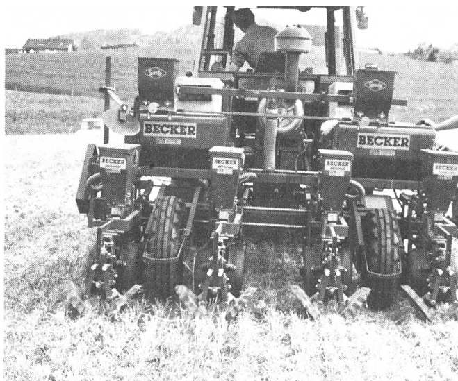
Abb. 6: Die Mais-Direktsaat nach geschlegeltem Grünroggen erfordert schwere und teure Spezialmaschinen oder eine gezielte Bodenlockerung, Saatbettbereitung und übliche Einzelkornsäat.
