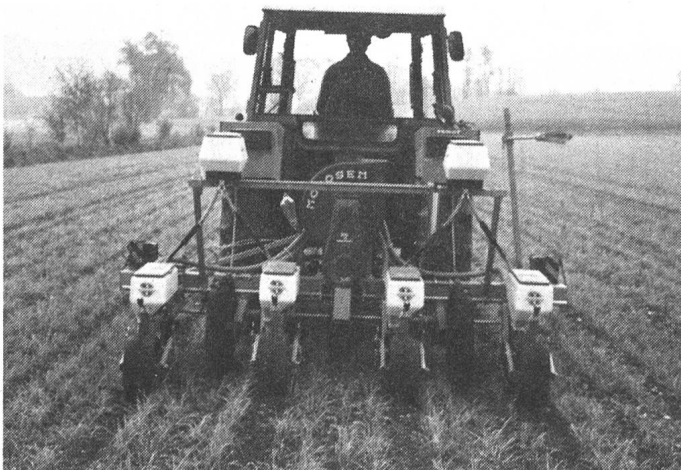
Abb. 5: Die Mais-Direktschachtsaat nach abgetötetem Grünroggen kann auf spurfreien Böden auch mit herkömmlichen Einzelkornsämaschinen mit Schneidscheiben durchgeführt werden (links). Schwere Maschinen sind allerdings vielseitiger einsetzbar (rechts).
