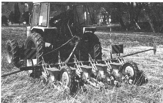
Abb. 1: Eine Mulchsaatausrüstung mit Doppelschneidscheiben und Tiefenführungsrollen, gut integrierten Säscharen sowie Scheibenzustreicher sichern eine verstopfungsfreie Direktsaat von Rüben (links) und Mais (rechts).
