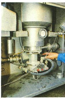
Die beim Ansaugen der Milch mitgerissene Luft wird über den Luftabscheider evakuiert. Dahinter ist das Leitungsstück mit der magnetisch induktiven Messeinheit zu erkennen.
