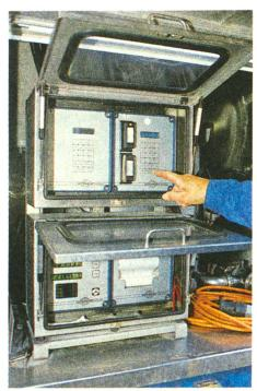
Blackbox auf dem Tankfahrzeug: Rechts oben sind die beiden Kassetten eingeschoben, von denen die obere die aktuellen Daten, die untere die Daten aus den 10 letzten Messungen speichert. Rechts davon das Feld für die manuelle Eingabe von Daten und Befehlen. Unten Digitalanzeige links und Papierausdruck rechts. Fotos: Zw.
