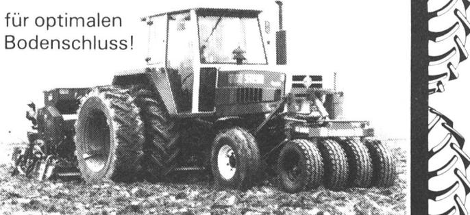
Verhindert Bodenverdichtung und erlaubt das Säen gleich nach dem Pflügen im Einmann-Passage-Verfahren.
