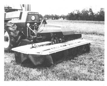
Der Antrieb erfolgt über einen Doppelzahn-Flachriemen und über Leichtmetall-Zahnriemenscheiben. Die Mähwerke werden trocken angetrieben, ohne Öl- oder Fettbad.
