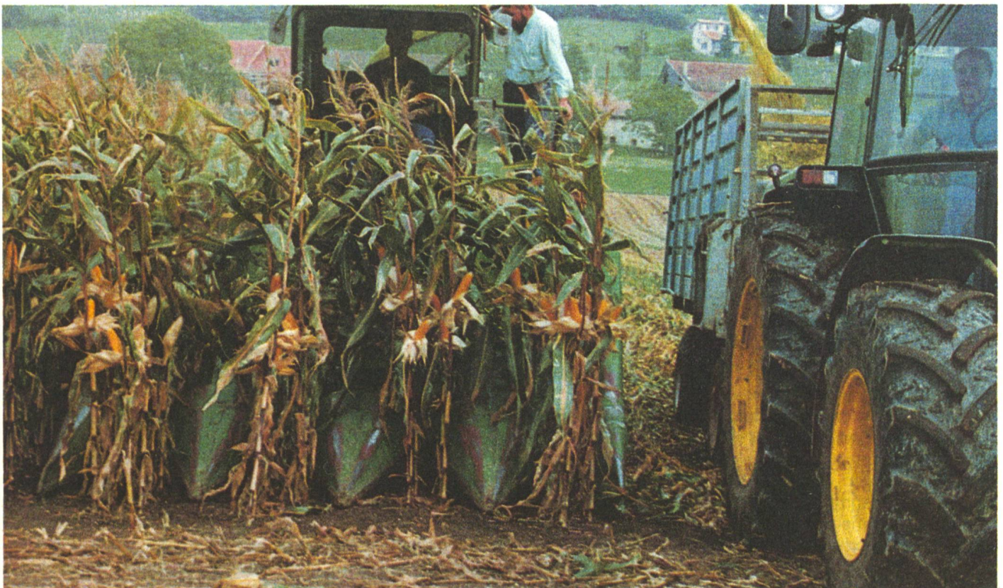
. . . sind verlustfreie Ernten mit normalen mehrreihigen Erntemaschinen möglich. Der Doppelreihenabstand beträgt auf diesem Feld 25 cm.
