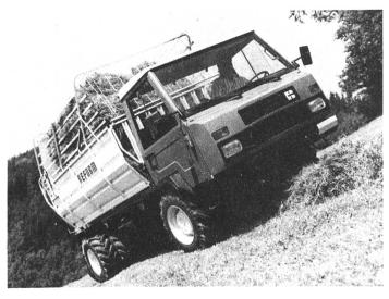
Der Muli 660 ist das neue Modell in der 60-PS-Leistungsklasse. Ausgestattet mit dem kraftvollen 5-Zylinder-Kubota-Dieselmotor verfügt der Muli 660 über 57,5 PS (42,3 kW) Leistung. Der Motor zeichnet sich durch hohen Drehmomentanstieg von ca. 25 Prozent und hervorragendes Durchzugsvermögen aus. Das neue Gruppen-Wendegetriebe verfügt über 16 Vor-/8 Rückwärtsgänge und sorgt für eine ausgewogene Geschwindigkeitsabstufung.
