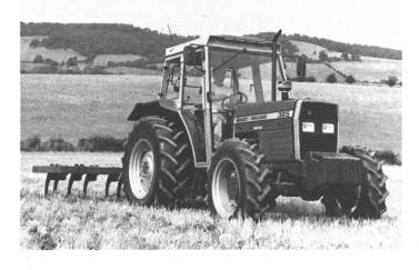
Der erfolgreiche MF 340 mit seinem 3-Zylinder Perkins-Motor 45 PS und 54 PS als Turbo, mit dem neuen Reversier-Vollsynchrongetriebe und mit Lenkradschaltung. Bevorzugt in den Alpenländern Öşterreich und Schweiz.
