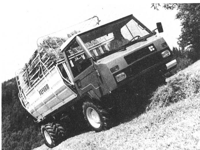
Der Muli 660 ist das neue Modell in der 60-PS-Leistungsklasse. Ausgestattet mit dem kraftvollen 5-Zylinder-Kubota-Dieselmotor verfügt der Muli 660 über 57,5 PS (42,3 kW) Leistung. Der Motor zeichnet sich durch hohen Drehmomentanstieg von ca. 25 Prozent und hervorragendes Durchzugsvermögen aus. Das neue Gruppen-Wendegetriebe verfügt über 16 Vor-/8 Rückwärtsgänge und sorgt für eine ausgewogene Geschwindigkeitsabstufung.
