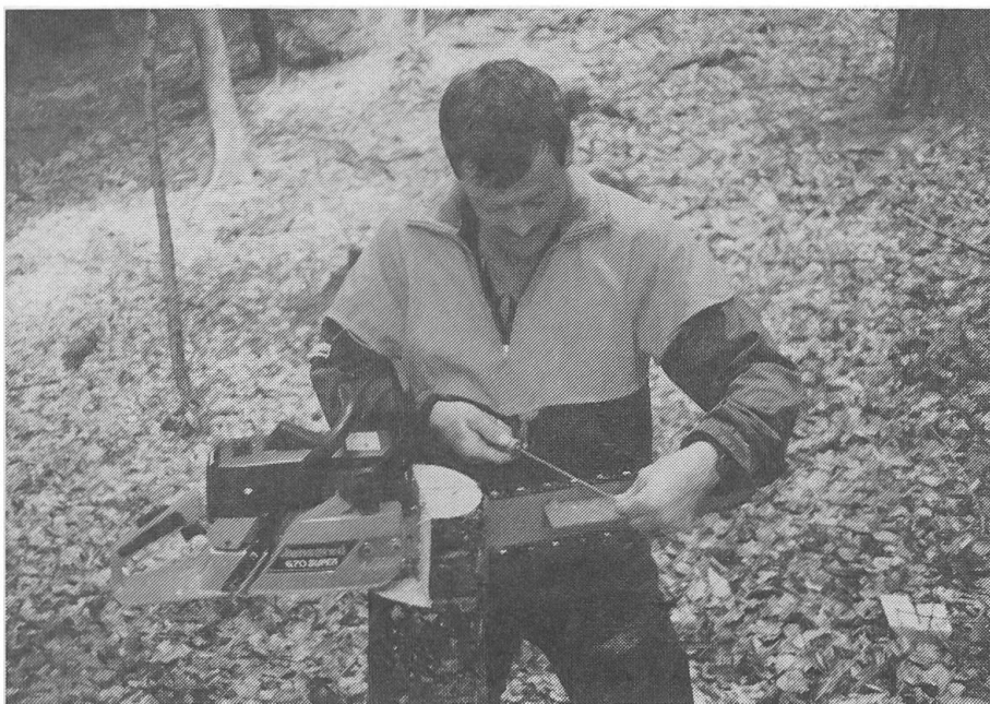
Mit einer stumpfen Kette hat auch die stärkste Motorsäge keine Leistung. Es gilt deshalb: «Gut geschärft ist halb gesägt». (Foto: Archiv WVS)
