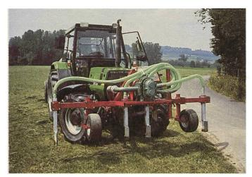
Gülleeinleger als Aufbau am Traktor mit einem konventionellen Druckfass (Vakuummat, Somag AG, Egnach)
