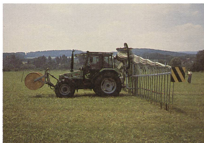
An der Zuger Maschinenvorführung wird das Schleppschlauch-Verteilsystem (Vogelsang/Hadorn) auch als Aufbau an der Traktorhydraulik mit der Zuleitung der Gülle über die Verschlauchung gezeigt.
