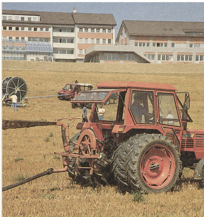
Schwenkverteiler (Fankhauser). Bei zu engem Querschnitt der Zuleitung wächst der Reibungswiderstand an der Rohrinnenwand überproportional an.
