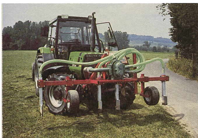
Güleeinleger als Aufbau am Traktor mit einem konventionellen Druckfass (Vakuummat, Somag AG, Egnach)
