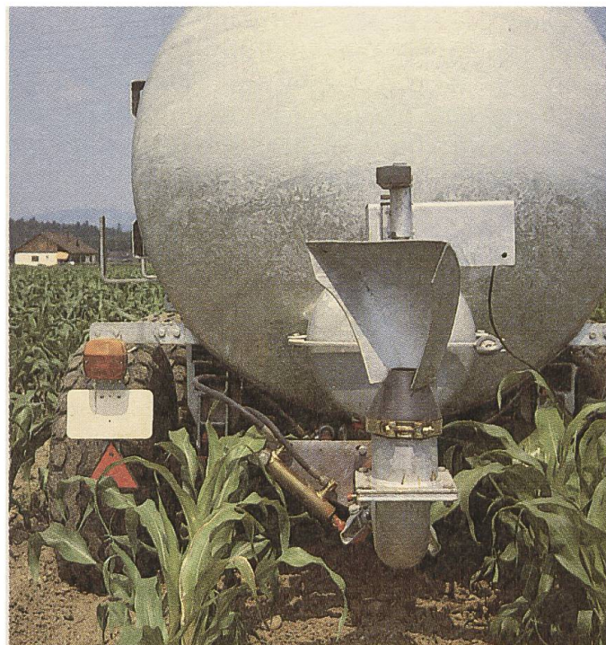
Der Schwenkverteiler Elomax (Armatec), vorgeführt durch Mathys AG, Huttwil, überzeugt durch die sehr genaue Gülleverteilung.
