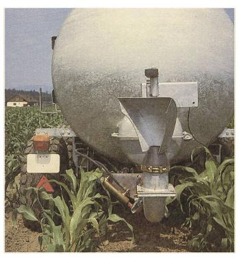
Der Schwenkverteiler Elomax (Armatec), vorgeführt durch Mathys AG, Huttwil, überzeugt durch die sehr genaue Gülleverteilung.
