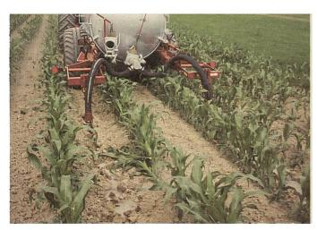
Gülleeinleger mit hydraulischem Zinkeneinzug
