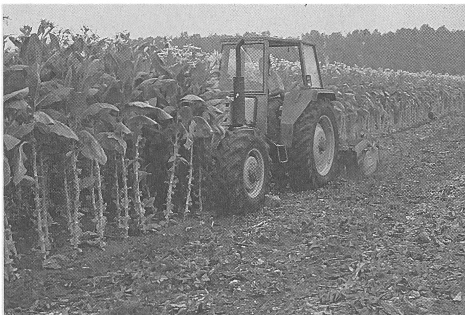
Abb. 4: Grosse Mengen an Pflanzenrückständen werden mit dem Dyna-Drive verstopfungsfrei in die obersten Bodenschichten eingemischt: Stoppeln, Getreide- oder Maisstroh, Stallmist, Gründüngungen. Für das Zerkleinern und Einarbeiten von abgeernteten, noch stehenden Tabakbeständen braucht der bodenangetriebene Doppelzinkenrotor nur halb so lang wie der zapfwellen-getriebene Zinkenrotor.
