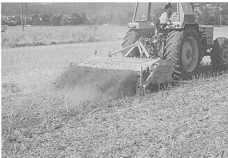
Abb. 3: Der Doppelzinkenrotor ermöglicht ein auf die gewünschte Tiefe gut einstellbare und schlagkräftige Stoppelbearbeitung. Im Vergleich mit einer dreibal-kigen Spatenrollegge ergab sich mit dem Dyna-Drive auf Leimboden ein mehr als doppelt so guter Ausgang der ausgefallenen Körner.
