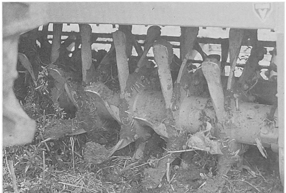
Abb. 2: Der Dyna-Drive ist mit ineinander greifenden, selbstreinigenden 4 cm breiten Löffelzinken ausgestattet, die eine Arbeitstiefe von 3–14 cm erreichen. Der Frontrotor wird durch die Vorfahrt über den Boden, der Heckrotor über eine Zahnradkette vom Frontrotor mit dreifacher Umfangsgeschwindigkeit angetrieben. Dank der sehr niedrigen, bodenschonenden Rotordrehzahl beträgt die Nutzungsdauer eines Zinkensatzes zwischen 400 und 1200 ha.
