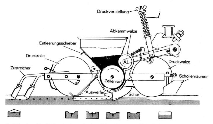
Fig. 1: Einzelkorn-Sägerät mit senkrecht angebrachtem Zellenrad. Im unteren Teil der Abbildung sind die Schnittprofile nach den einzelnen Werkzeugen zu sehen.
