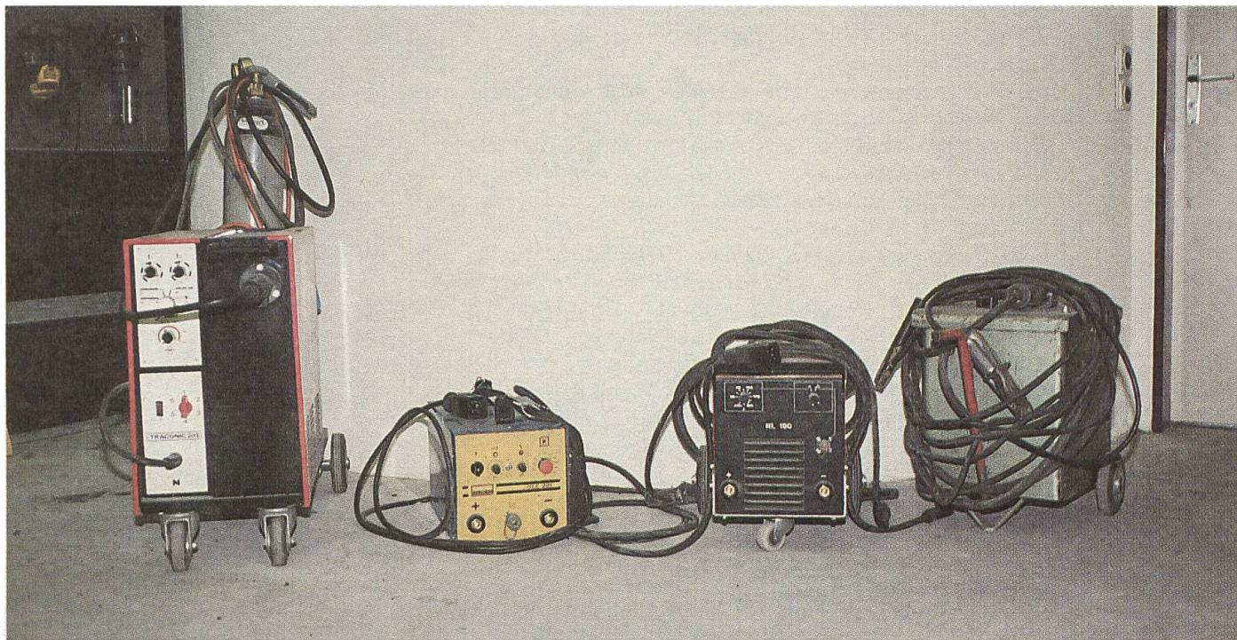
eine grosse Festigkeit verlangt wird, Verunreinigungen des Metalles vorliegen und die Stahlqualität nicht genau bekannt ist, auf die Verwendung eines Elektrodenenschweissgerätes zurückgreifen. Diese sind, wenn der Elektrodenwahl die nötige Beachtung geschenkt wird, sehr vielseitig einsetzbar.
