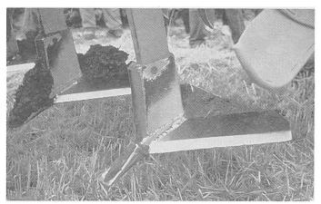
Schichtengrubber. Ein schmales Spitzschar ist mit gänsefussartigen Flügeln ausgerüstet. Die durchschnittlich 40 cm breiten Flügelschare ermöglichen ein ganzflächiges Durchschneiden des Bodens – bei verhältnismässig hohem Zugkraftbedarf. Sie hinterlassen eine beinahe ebene und kaum zerstörte Oberfläche, ohne Pflanzenrückstände einzuarbeiten. Daher werden Flügelschare meist in Kombination mit Kurzgrubbern und Zapfwellengeräten eingesetzt.
