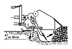
Pendel-Spatenmaschine. Die auf einer Kurbelwelle angebrachten Einzelspaten stechen senkrecht in den Boden ein und werfen ihn nach hinten/oben gegen ein Prallblech. Als Pflugersatz arbeitet die Pendel-Spatenmaschine insbesondere auf schweren. «nassen» und zerfurchten Tonböden nach späträumenden Kulturen bodenschonend. Sie hinterlässt eine grobschollige Bodenstruktur ohne Verdichtungshorizonte.
