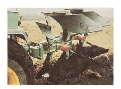
Der Pflug – das klassische Bodenbearbeitungsgerät schlechthin. Obschon Nachteile wie Bodenstrukturschäden sowie hoher Energie- und Zeitaufwand gegen den Pflugeinsatz sprechen, kann er die Aufgaben des Wendens, Bröckelns und Lockerns («Aufwurf») erfüllen. Hierzu ist er bei trockenen und warmen Bodenbedingungen einzusetzen, um infolge «Lebendverbauung» durch Mikroorganismen und Kleintiere die Bodenstruktur zu stabilisieren.
