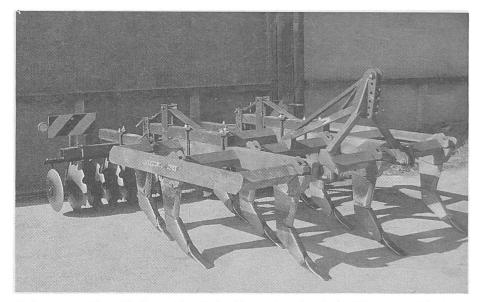
Schwergrubber. Unterschiedliche Bauarten (mehrbalkig; verschiedene Strichabstände, Scharformen und Einzugswinkel) ermöglichen vielfältige Einsatzmöglichkeiten. Starre Meisselzinken mit Schmalscharen und flachem Einzugswinkel haben eine beschränkte Mischwirkung. Als Pflugersatz kann eine Bearbeitungstiefe von 25 – 30 cm nur bei grossem Strichabstand eingehalten werden. Die somit grobschollige Bodenoberfläche wird mit einem kombinierten Nach-Laufgerät sogleich ausgeebnet.
