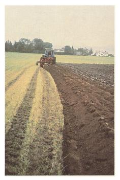
Variable Schnittbreite. Pflüge mit stufenloser Schnittbreitenverstellung werden meist hydraulisch betätigt. Als Vorteil gilt das rasche und einfache Anpassen der Arbeitsqualität unter wechselnden Einsatzbedingungen (aufwärts/abwärts pflügen; Hindernisse umpflügen; Grenzpflügen). Nachteile sind der ca. 20 % höhere Anschaffungspreis und der grössere Wartungsaufwand.
