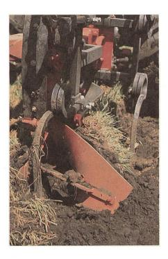
Lockerungszinken. Der Vorteil dieser mit einem Schmal- oder Gänsefussschar ausgestatteten Spiralfederzinken ist die zusätzliche Lockerung der befahrenen Furchensohle, unmittelbar hinter dem Traktorrad. Wird 15 cm unter der Pflugsohle gelockert, so steigt der Zugkraftbedarf um 15 – 20 %. Die Zusatzeinrichtung ermöglicht ein flaches Pflügen mit gesonderter Lockerungswirkung (Förderung des Rotteverlaufes).
