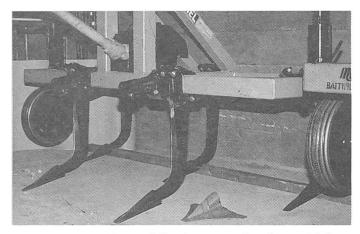
Unterbodenlockerer. Mit einem zapfwellengetriebenen Unterbodenlockerer soll durch den Zwangsantrieb der Zinken und Scharen (Spitz-, Gänsefussscharen) ein intensives Aufbrechen von Störschichten im Unterboden sowie eine Verringerung des Zugkraftbedarfes erziehlt werden. Schlupf und entsprechende Beeinträchtigung der Ackerkrume sollten durch die bewegten Lockerungswerkzeuge vermindert werden.
