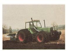
Offset-Pflügen mit Doppelbereifung. Durch die auf der Furchensohle laufenden Traktorräder sowie im Unterboden verursachten Verdichtungen können weitgehend vermieden werden, wenn die Antriebsräder ausserhalb der Furche laufen. Wegen problematischer Zugpunktführung in Hanglagen sehen Pflugkonstrukteure noch keine praxisreifen Lösungsmöglichkeiten bei Zwei- und Dreischarpflügen. Vier- und mehrscharige Prototypen existieren bereits.
