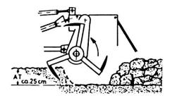
Rotations-Spatenmaschine. Die Wirkungsweise der Spatenmaschine ist das Rotations- oder das Stich-Wurf-Prinzip. Bei ersterem sind die Werkzeuge auf einer durchgehenden Welle versetzt gegeneinander angeordnet. Sie bewegen sich ähnlich wie bei der Bodenfräse. Bei feuchten Bodenverhältnissen kommt es zu Schmierschichtbildung.
