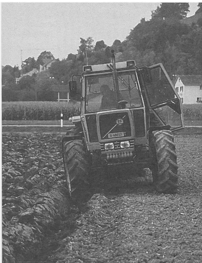
Abb. 5: Muss sich die Bodenbelastung durch das Pflügen jährlich wiederholen? – Das Rad in der oft feuchten Pflugfurche verursacht Schadverdichtungen.
