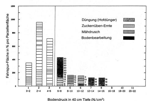
Abb. 4: Druck-Fahrspurflächen-Diagramme für die **Unterbodenbeanspruchung** während sieben Jahren Ackerbau. Die Fahrspurflächen-Summen (Säulen) vermitteln ein Bild von den flächenhaften Beanspruchungen in den einzelnen Druckbereichen. Kritisch sind im Unterboden die Belastungen von über 6 N/cm² (1 N/cm² ≈ 0,1 kp/cm²).
