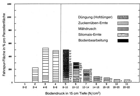
Abb. 3: Druck-Fahrspurflächen-Diagramme für die **Oberbodenbeanspruchung** während sieben Jahren Ackerbau. Die Fahrspurflächen-Summen (Säulen) vermitteln ein Bild von den flächenhaften Beanspruchungen in den einzelnen Druckbereichen. Kritisch sind im Oberboden die Belastungen von über 8 N/cm² (1 N/cm² ≈ 0,1 kp/cm²).
