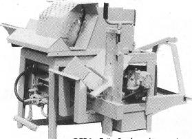
GEBA «Fräs-Spalter» fräst und spaltet das Brennholz in einem Arbeitsgang. Typ FS-Z für Zapfwellenantrieb ,FS-ZE für Zapfwellenantrieb und aufgebautem 9,5 kW Elektromotor.
